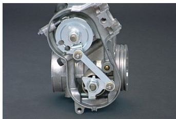
Tringlerie des gaz progressive
